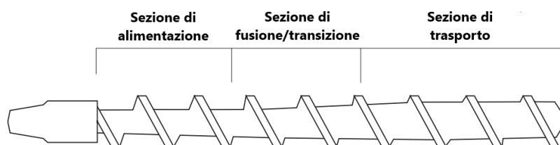
Figura 4.18 - Struttura base di una vite di estrusione (Kalpakjian & Schmid, 2014)
