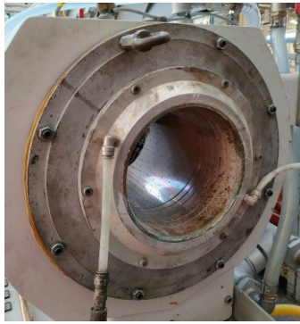
Figura 5.3 - Calibro posizionato all'imbocco della prima vasca di raffreddamento
