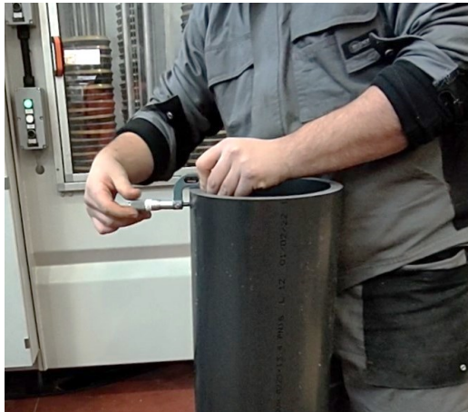
Figura 5.12 - Misura dello spessore di un campione di tubo mediante il calibro
