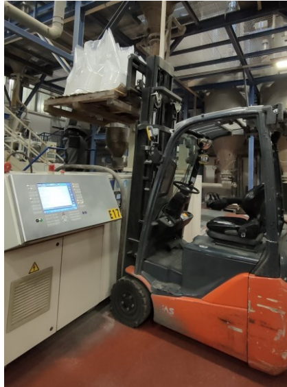
Figura 6.30 - Posizionamento dei sacchi con la mescola di fermata
