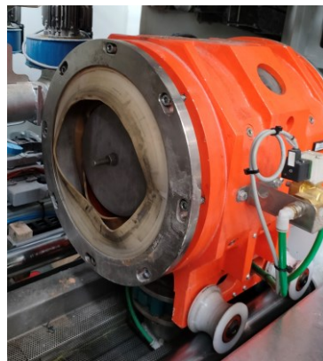
Figura 5.8 - Botte per la formazione del bicchiere, con doppia gomma per la tenuta del vuoto
