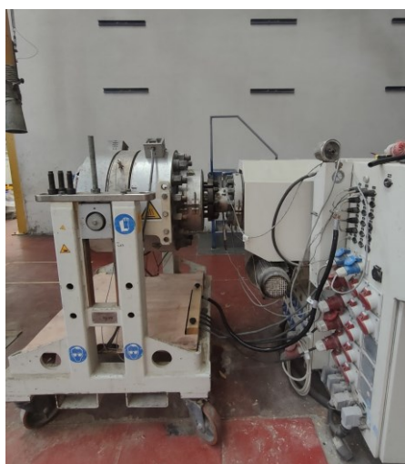
Figura 6.25 - Prototipo del nuovo sistema di supporto dei cavi e delle sonde
