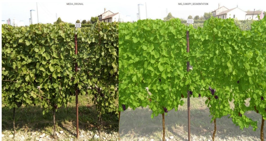
Fig. 2.16 Fotografia originale (a sinistra) e ricezione della stereocamera dei pixel che identificano le principali parti della fotografia: chioma, fusto, grappoli (a destra). Fonte: software Aurora
