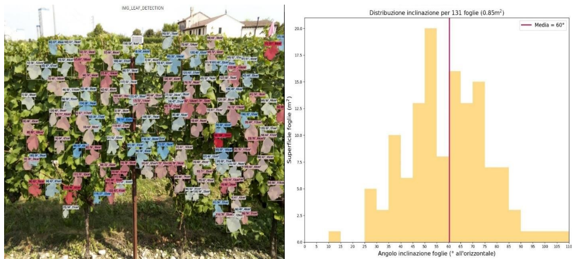
Fig. 2.18 Esempio di fotografia processata dal programma leaf detection e istogramma relativo alla distribuzione della media delle inclinazioni fogliari
