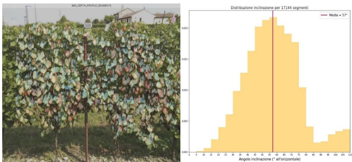
Fig. 2.20 Fotografia processata dal programma depth profile e istogramma relativo della distribuzione della media dell'inclinazione dei singoli segmenti individuati nella fotografia
