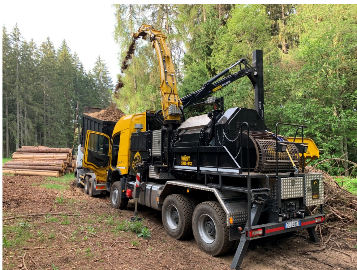
Foto 2: cippatrice su autocarro in azione in uno dei cantieri analizzati (Foto di Nicola Baldessari)
