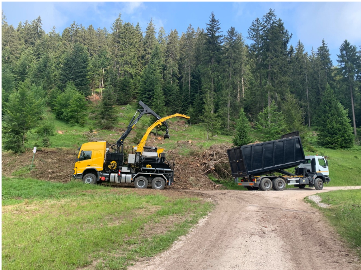
Foto 3: cippatrice su autocarro in azione di caricamento di un autocarro con cassone utilizzato per il trasporto del cippato al piazzale di deposito temporaneo (Foto di Nicola Baldessari)
