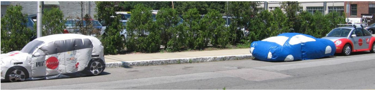
Figura 2.25 – Scenario di riferimento per i test di parcheggio. Fonte: [22].
