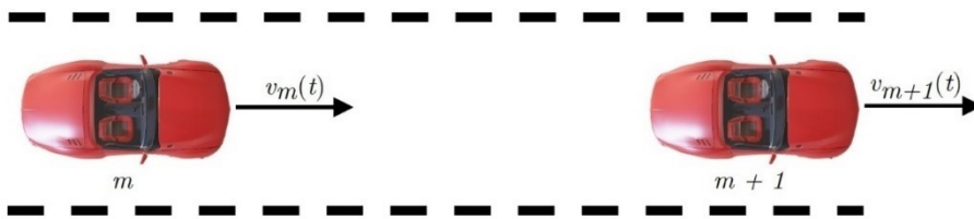
Figura 2.18 - Modello di car-following generalizzato. Fonte: [18]
