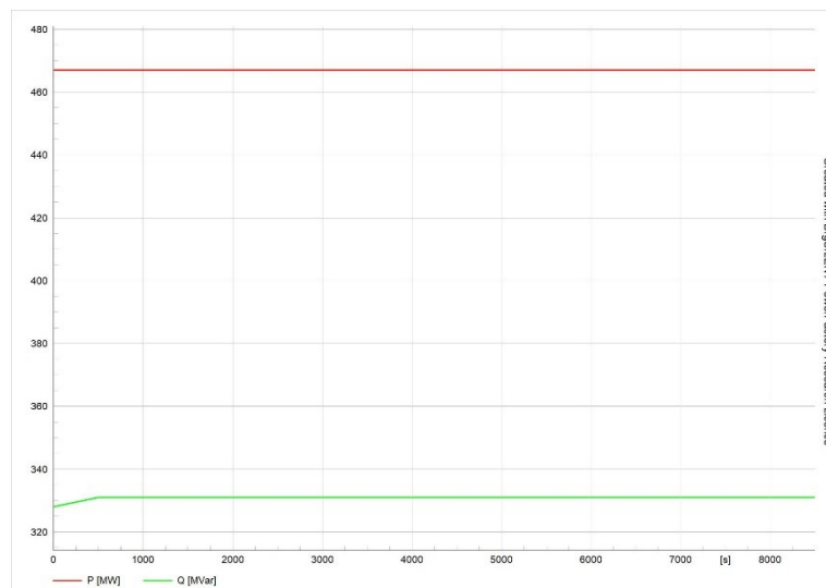
Figura 4.8: Profilo di potenza del sistema MLVN con accoppiamento diretto WCLL
