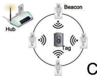
Figura 14 Sistema automatizzato di rilevazione della caduta [4].
