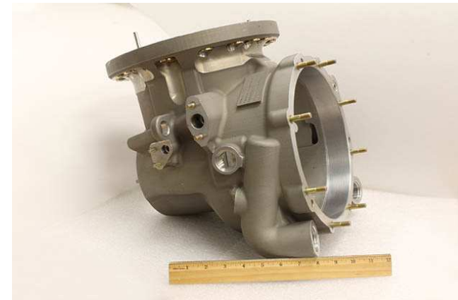
Figura 4. Alloggiamento trasmissione dell'elicottero Chinook CH-47 di Boeing.
