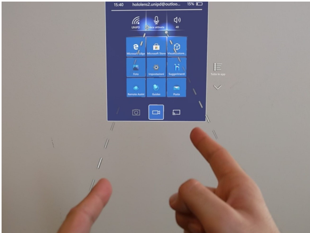
Figura 4.22: Nella selezione a distanza, due fasci luminosi rappresentano la posizione delle dita nello spazio
