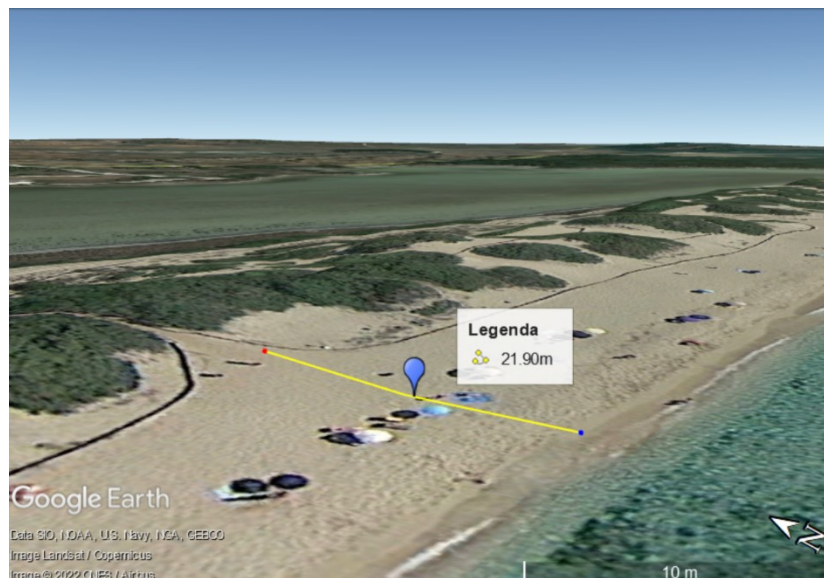
Figura 11 – Esempio di calcolo dell'ampiezza di una spiaggia attraverso l'utilizzo dello strumento righello
