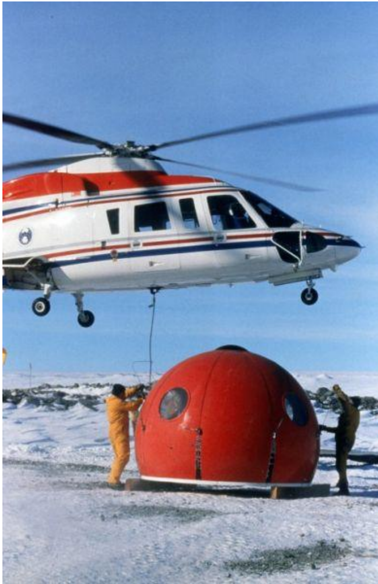
Figura 24_trasporto di un Igloo prefabbricato
