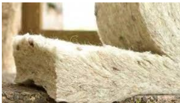
Figura 7_dettaglio isolante in lana di pecora
