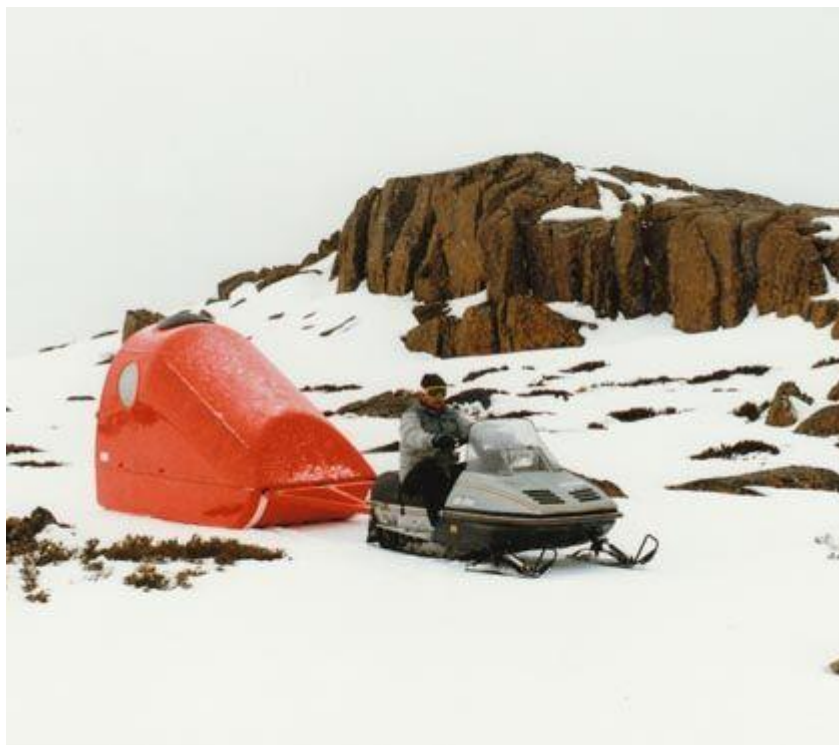
Figura 25_trasporto di un Igloo prefabbricato
