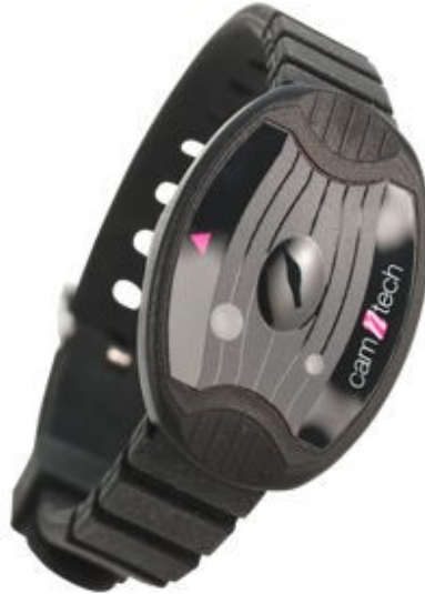
Figura 2. 1 Attigrafo da polso modello MotionWatch 8 (CamNtech, Cambridge, UK; Figura 2.2)
