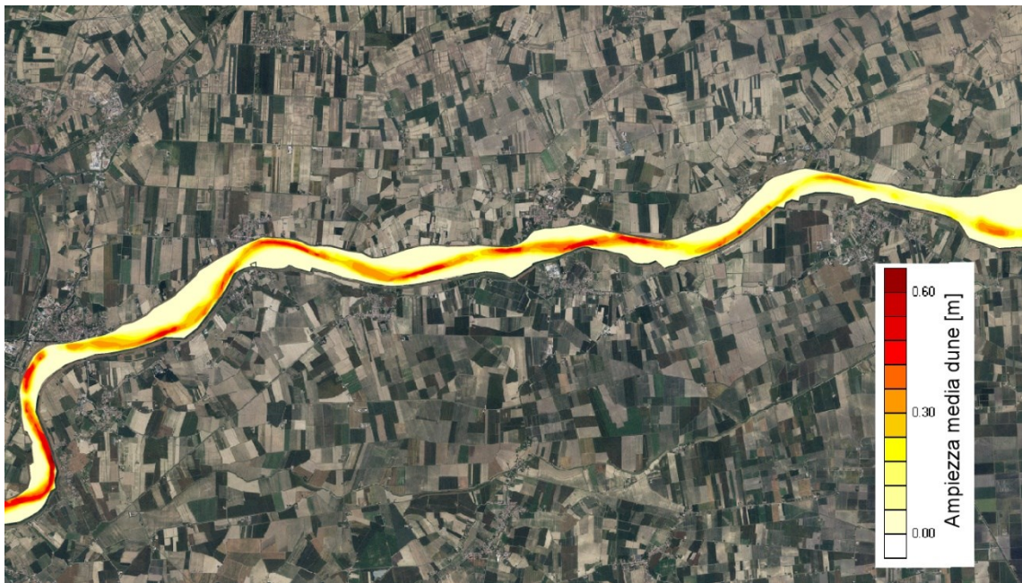
Figura 3.24: Distribuzione spaziale dell'ampiezza delle dune calcolate, per un valore di portata di 800 \text{ m}^3/\text{s} , nel "tratto 2" da Polesella all'incile del Po di Goro.
