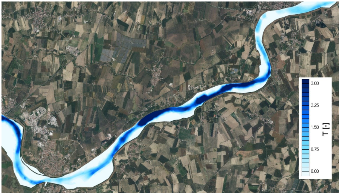
Figura 3.19: Distribuzione spaziale del parametro T , per un valore di portata di 600 \text{ m}^3/\text{s} , nel "tratto 1" da Pontelagoscuro a Polesella.
