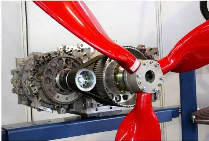
Figura 5.2: Esempio Trasmissione Cinghia per applicazioni aeronautiche
