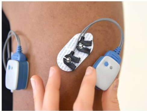
Figura 7. Esempio di un elettromiografo di superficie wireless usato nel caso di studio (Ultium EMG,Noraxon Inc)
