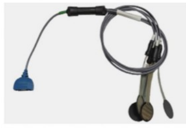
Figura 4. Esempio di Footswitch di tipo FSR usato nel caso di studio (Force Sensitive Resistor)
