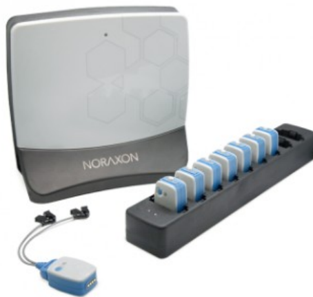
Figura 12. Esempio di un DAQ multicanale utilizzato nel caso di studio (Noraxon Inc)
