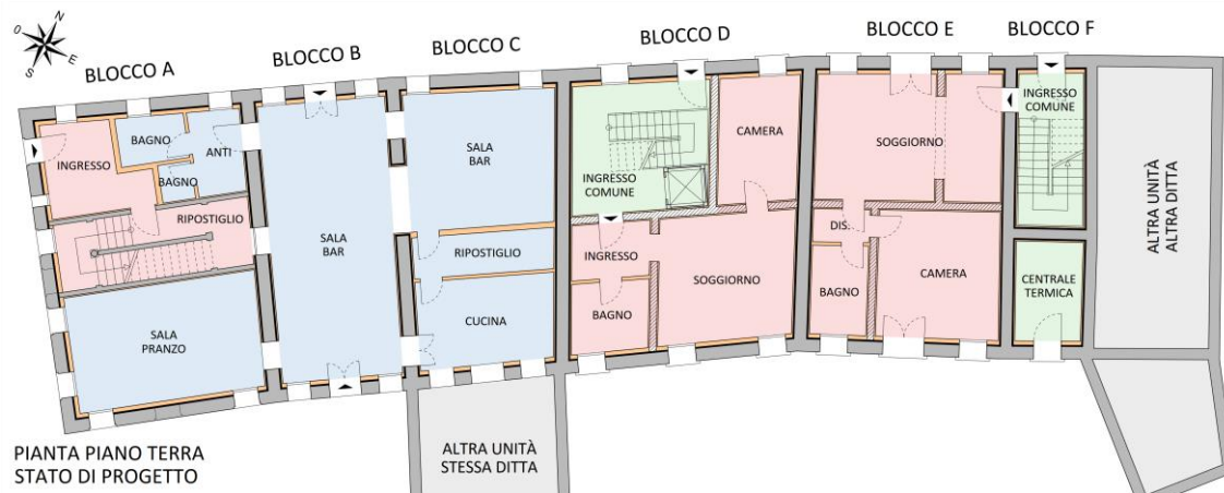
Figura 6.4.15: Pianta piano terra Stato di progetto - scala generica
