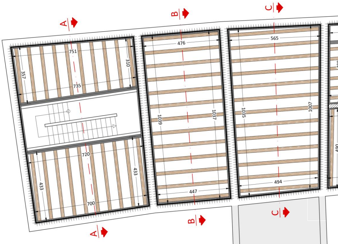
Figura 6.4.3: Pianta solaio piano terra dei blocchi A,B,C
