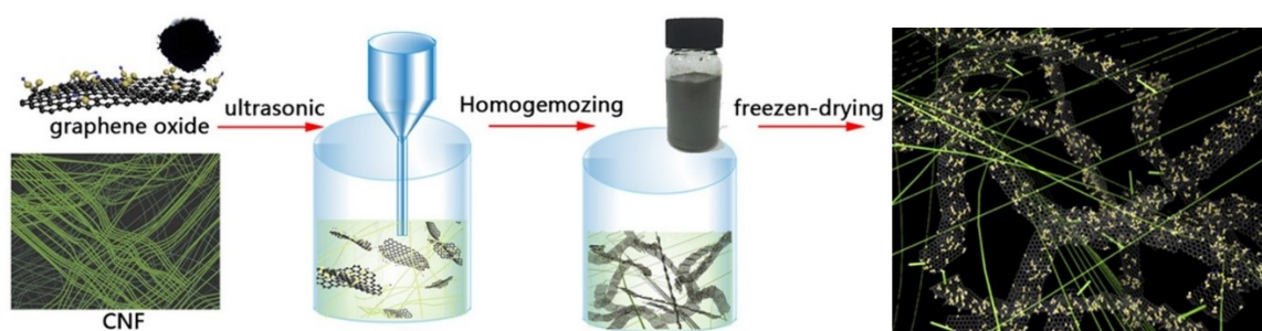
Figura 4.1: Schema delle fasi di sintesi dell'aerogel CNF/GO. 23
