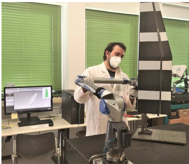
Figura 168 – Procedura di scansione dell'ala.
