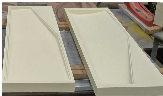
Figura 154 - Stampi ala Kowalsky ottenuti tramite fresatura a controllo numerico di un blocco di poliuretano ad alta densità.
