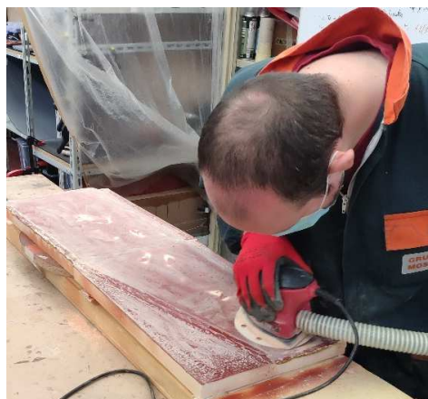
Figura 155 - Processo di lucidatura degli stampi dopo l'applicazione del gelcoat.
