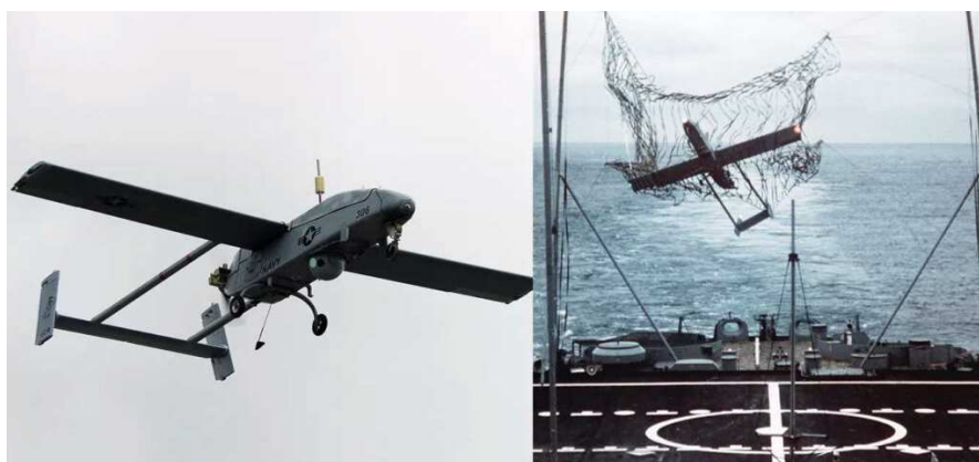
Figura 9 - Drone RQ2 Pioneer e sistema di recupero in mare tramite rete, foto da [1].
