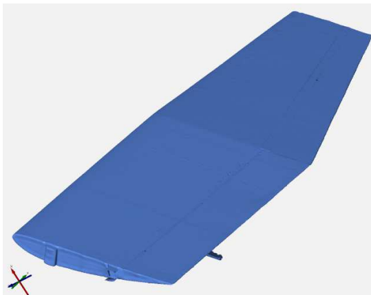
Figura 179 - Modello poligonale finale dell'ala scansionata, dettaglio intradosso.
