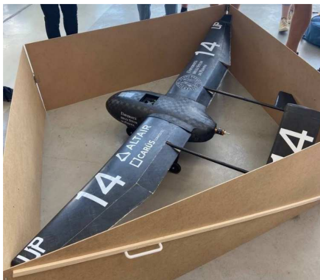
Figura 40 – Durante l'ispezione tecnica, viene verificato che il drone Kowalsky rispetta il requisito secondo cui deve essere contenuto all'interno di un rombo con lati di 1,5\text{m} .
