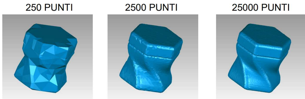
Figura 160 – Effetto del numero di punti acquisiti via scanner sul grado di dettaglio del modello virtuale, figura da [49].
