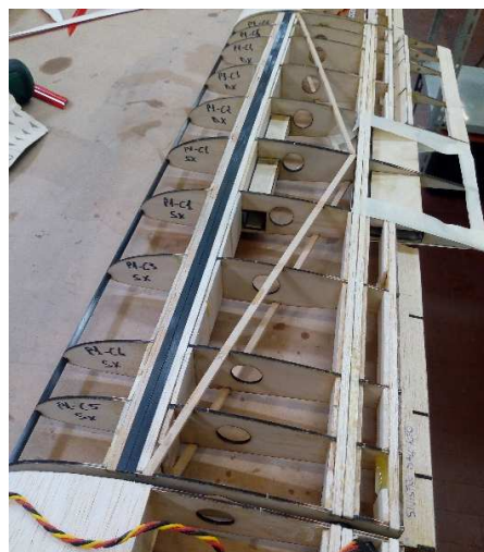
Figura 29 - Dettaglio della struttura interna dell'ala di Marcoplano.
