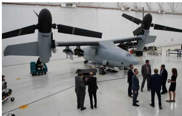
Figura 22 – Mockup del drone VTOL Bell V-247 Vigilant, la cui entrata in produzione è prevista per il 2023.
