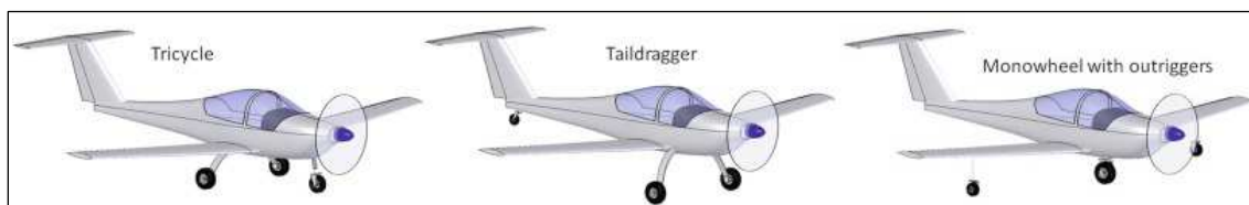
Figura 75 - Configurazioni del carrello di atterraggio valutate durante il design concettuale del velivolo, figura da [15].
