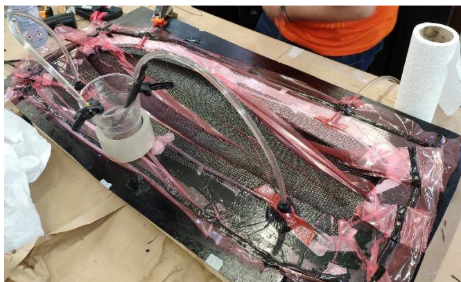
Figura 28 - Realizzazione di un semi-guscio della fusoliera di Marcoplano mediante VARTM (Vacuum Assisted Resin Transfer Molding).
