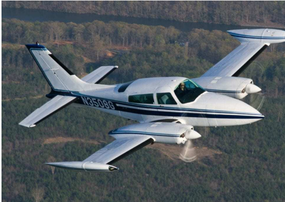
Figura 70 - Cessna 310R, esempio di propulsione ad elica traente.
