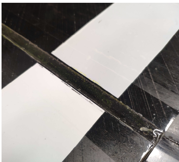
Figura 158 - Dettaglio dello scotch impiegato per chiudere la cerniera del flap.
