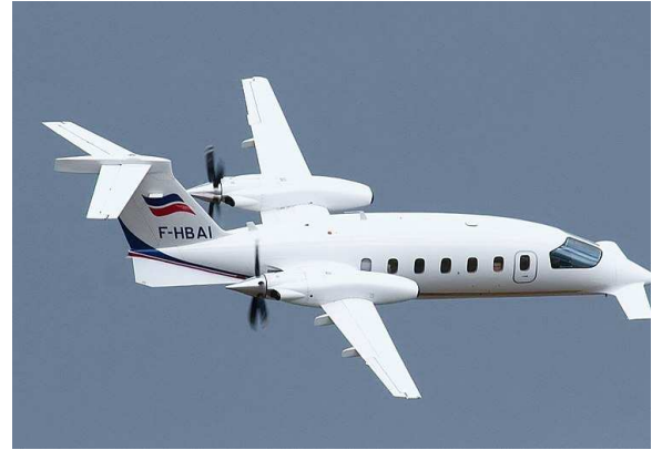
Figura 71 - Piaggio P.180 Avanti, esempio di propulsione ad elica spingente.
