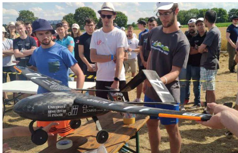
Figura 41 - Test di carico statico sul drone Kowalsky prima del volo alla Air Cargo Challenge 2022.
