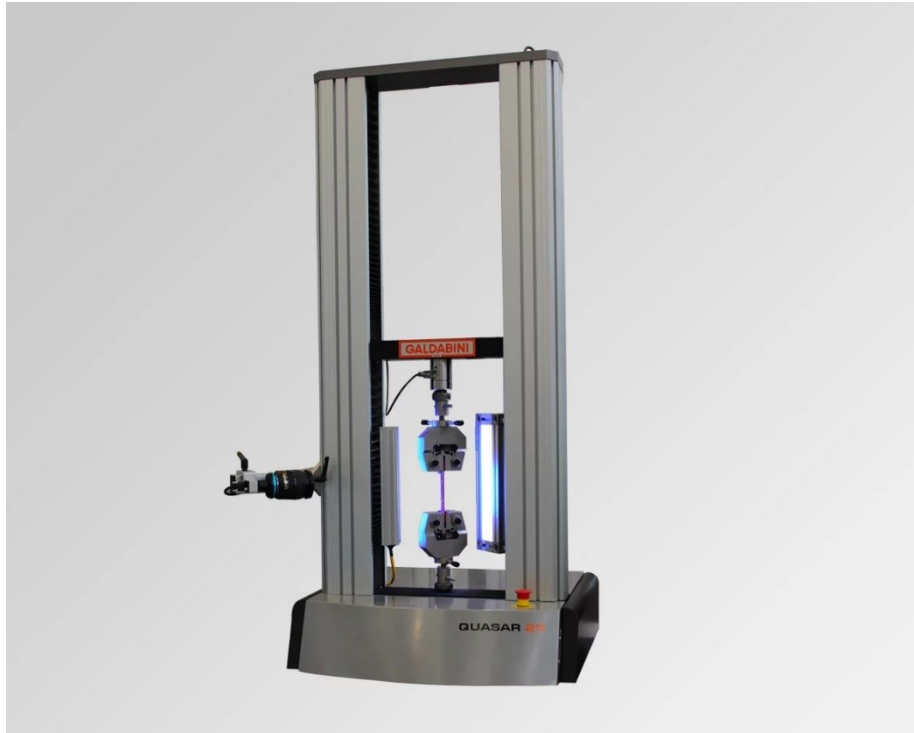
Figura 8.11 Immagine della macchina utilizzata per le prove a compressione.
