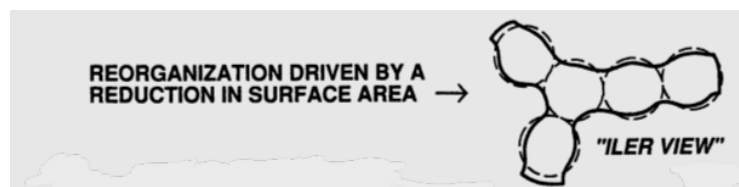
Figura 5.7 Rappresentazione dello step di ingrossamento, ovvero formazione di colli tra le particelle di gel.
