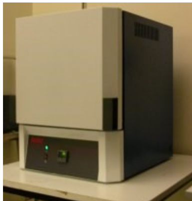
Figura 8.6 Immagine del forno a muffola utilizzato per il trattamento in aria.
