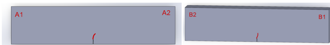
Figura 5. 29: Modalità di propagazione di cricca ("a sella")
