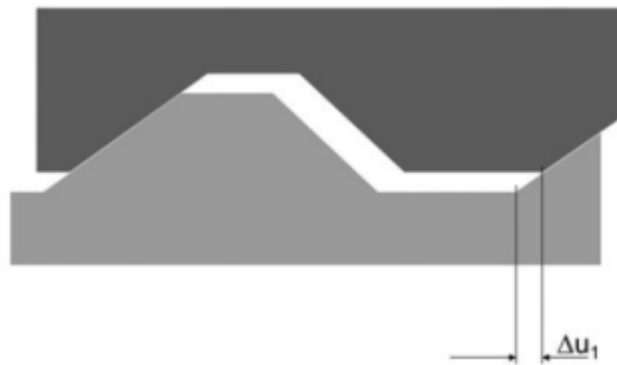
Figura 1.14 Chiusura della cricca per effetto della rugosità [5]
