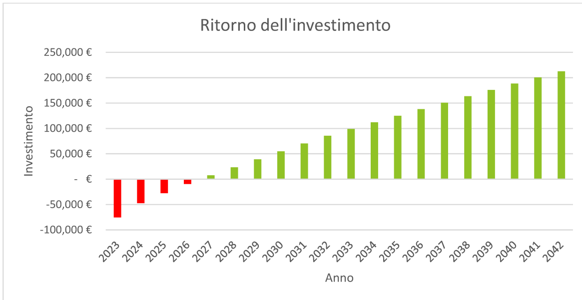
Figura 63, grafico ritorno investimento impianto 100 kWp
