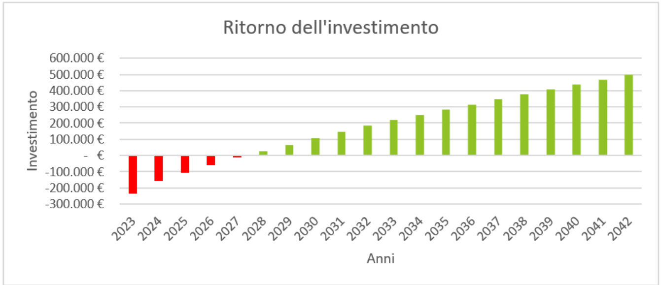
Figura 70, grafico ritorno investimento impianto 300 kWp
