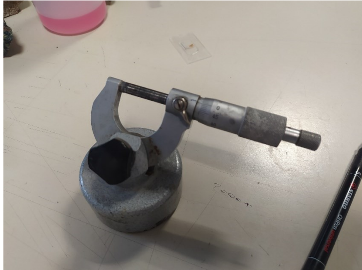
Figura 34. Strumento utilizzato per misurare lo spessore della sezione.
