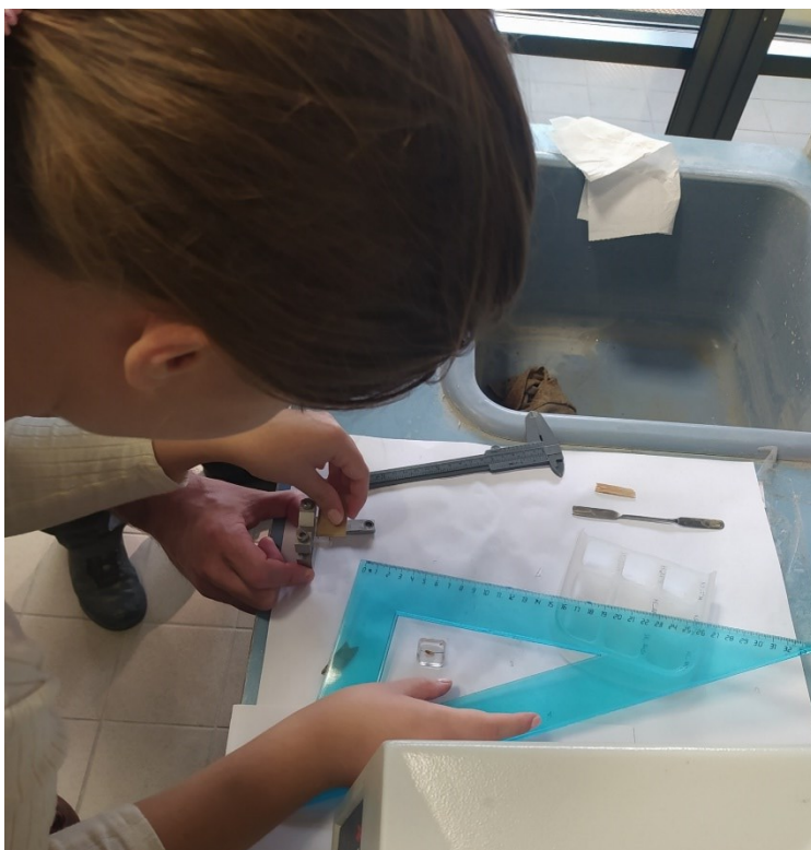
Figura 32. Montaggio del campione all'holder.
