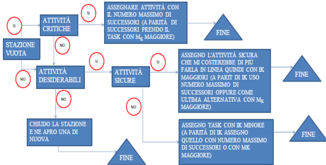
Figura 2.1 procedimento di risoluzione Kottas & Lau
