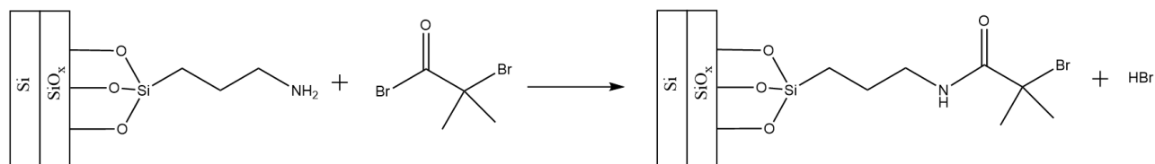
Figura 2.9: Immobilizzazione dell'iniziatore ATRP sulla lastra di silicio funzionalizzata.
