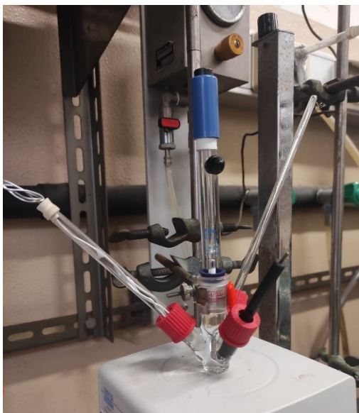
Figura 4.3: cella elettrochimica utilizzata per le eATRP. In questo caso nella cella sono stati introdotti un SCE dal collo centrale e, nei colli laterali a partire da sinistra in senso orario: un CE di Al in cella separata, una retina di Pt, un disco di Pt.
