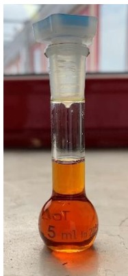
Figura 5.4: soluzione 0.2M di [\text{Pd}(\text{OAc})_2] in 5 mL di NMP.
