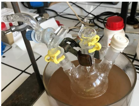
Figura 5.5: set-up sperimentale per la sintesi del trans -3-(4-metossifenil)propenoato di butile.
