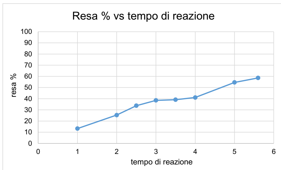
Figura 3.16: profilo cinetico della reazione di accoppiamento di Heck tra 4-bromoanisolo e n -butilacrilato (rapporto molare 0.025% catalizzatore/alogenuro).
