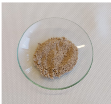
Figura 17. pDVB-SO 3 H dopo lavaggio, asciugatura in stufa a 110°C per una notte e macinazione (granulometria compresa tra 180 e 400 nm).
