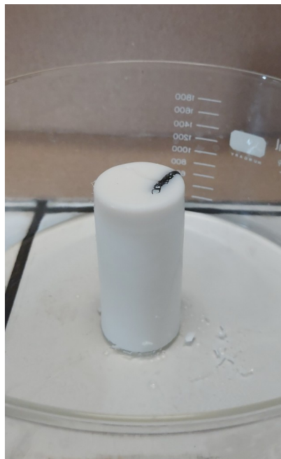
Figura 12. Monolite di pDVB allo stato rigonfiato ottenuto dalla polimerizzazione in un cilindro di Teflon.
