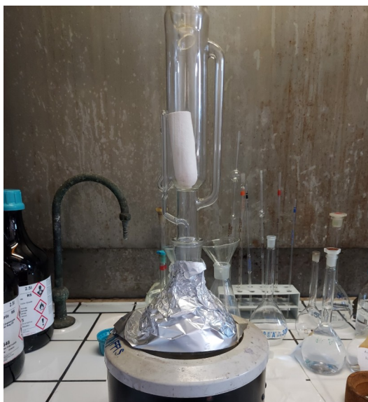
Figura 18. Estrattore soxhlet per il lavaggio della resina solfonica, inserita in un ditale di cellulosa.
