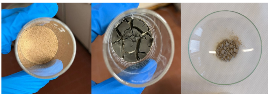
Figura 20. 1% wt Pd/pDVB-SO 3 H prima della riduzione (a sinistra), 1% wt Pd/pDVB-SO 3 H dopo la riduzione bagnata (in centro), 1% wt Pd/pDVB-SO 3 H dopo riduzione ed essiccamento (a destra).
