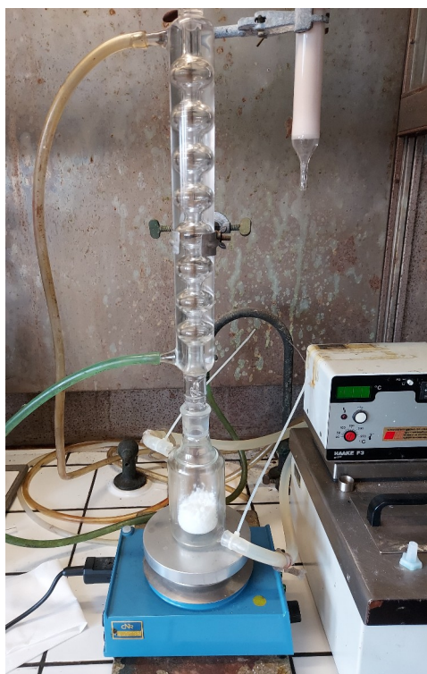
Figura 14. Setup strumentale per la solfonazione del pDVB.
