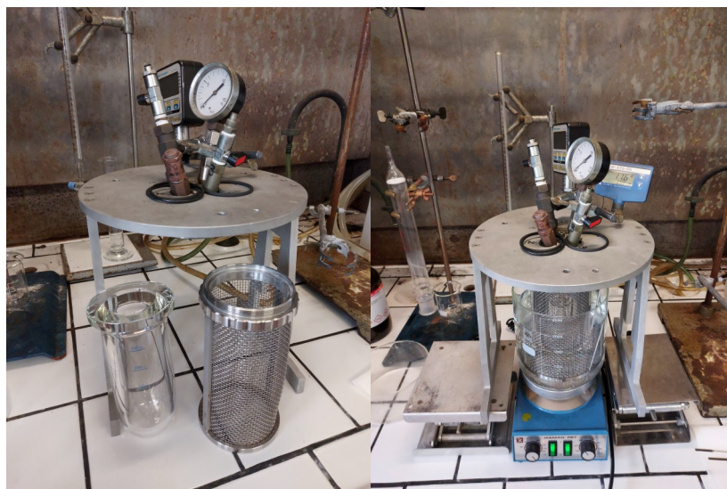
Figura 19. Autoclave di vetro utilizzata per la riduzione del palladio (II) sul supporto di pDVB-SO 3 H (a sinistra), autoclave durante la reazione (a destra).
