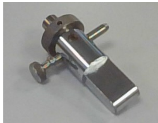
(d) Denting test pressing head for the Zwick AllroundLine.
