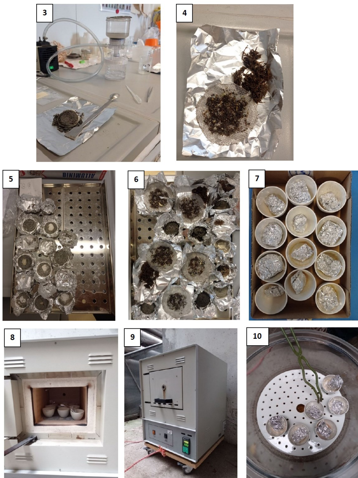
Figura 4.8: 1. Pesatura della stagnola, 2. Filtrazione del campione dal quale sono stati tolti gli organismi, 3. FPOM, 4. BPOM, 5-6. Contenitori pronti per il processo in stufa, 7. Stagnola ben chiusa messa nei crogioli, 8-9. Fase di combustione nella muffola, 10. Crogioli messi nell'essiccatore per il raffreddamento (Fotografie scattate dall'autore durante la fase di laboratorio – 2022).
