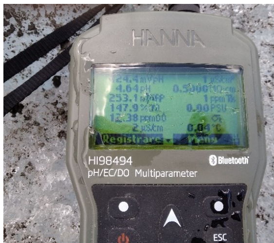
Figura 4.2: Misurazione dei parametri dell'acqua tramite sonda multiparametrica (modello HI 9829, Hanna Instruments)
