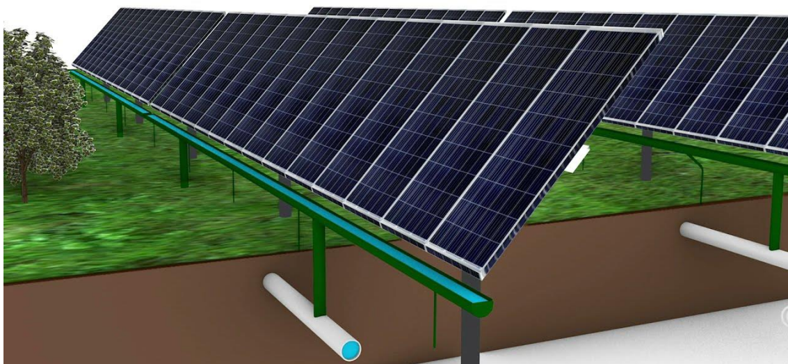
Figura 11- Sistema fotovoltaico con grondaie esterne per riciclo dell'acqua piovana e attuabile anche nei sistemi agrivoltaici (Rain water recovery)
