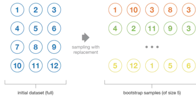
Figura 6.2: Esempio grafico della procedura di Bootstrap. Da un dataset di dati iniziale vengono estratti, con reinserimento, gli elementi del dataset per formare k campioni aventi tutti lo stesso numero di elementi.
