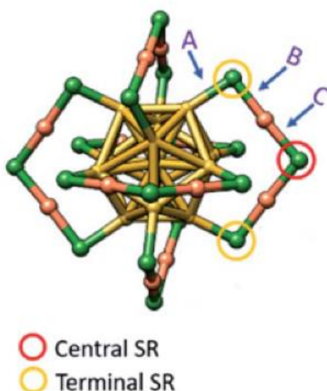
Figura 1.8 Struttura del MPC \text{Au}_{25} , con evidenziati i tre siti di attacco possibili (A, B e C) e le due tipologie di leganti tiolici ("terminali", leganti interni (inner); "centrali", leganti esterni (outer))
