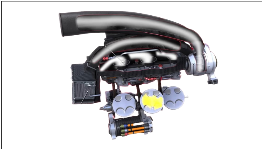
Fig. 7 Airscope e percorso aria di alimentazione del compressore.
