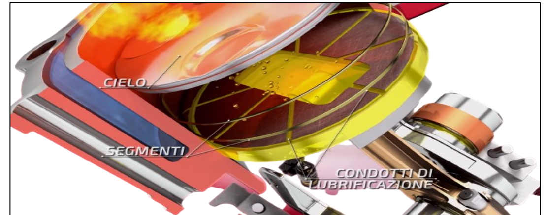
Fig. 3 Sistema dissipazione del calore del pistone.
