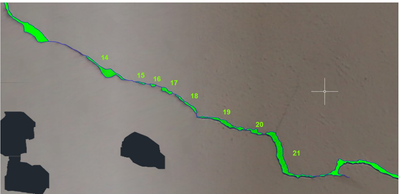
Figura 20: Dettaglio della restituzione della fessurazione nella chiesa a Rovegliana; anno 2019;
