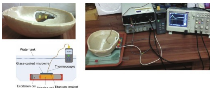
Figura 1.11: Misura della temperatura intracranica con impianto in titanio e confronto con temperatura rilevata tramite termocoppia [1]
