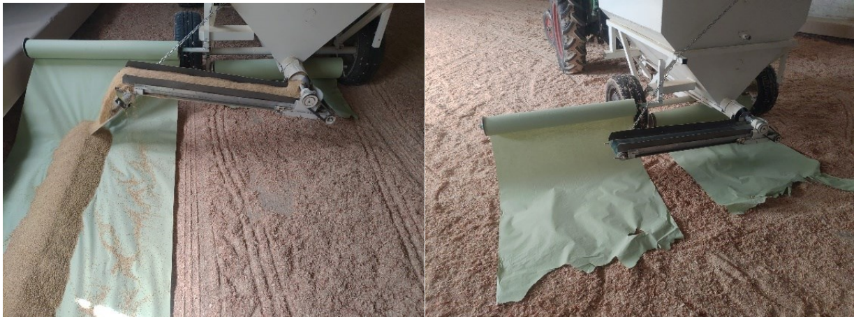
Figura 12. Distributore di mangime in funzione su un rotolo di carta (a sinistra) o due rotoli di carta.
