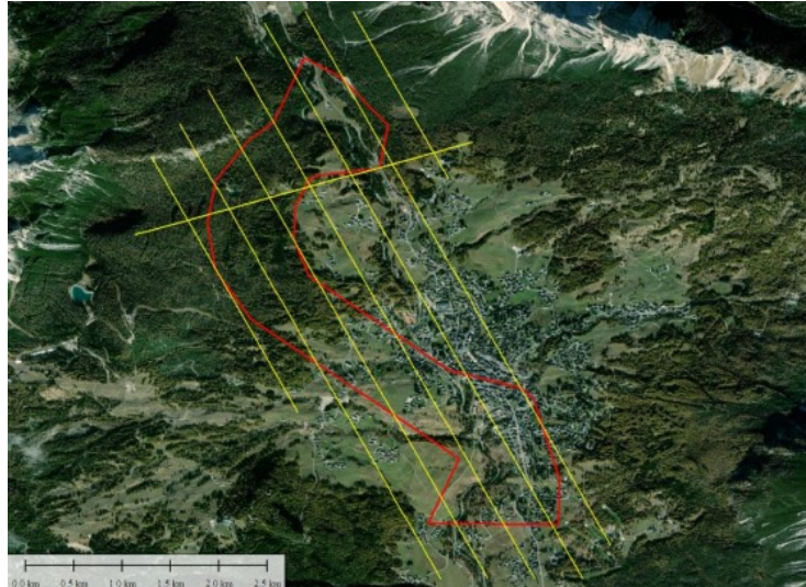
Figura 3: Traiettoria per l'acquisizione di dati laser scanner
