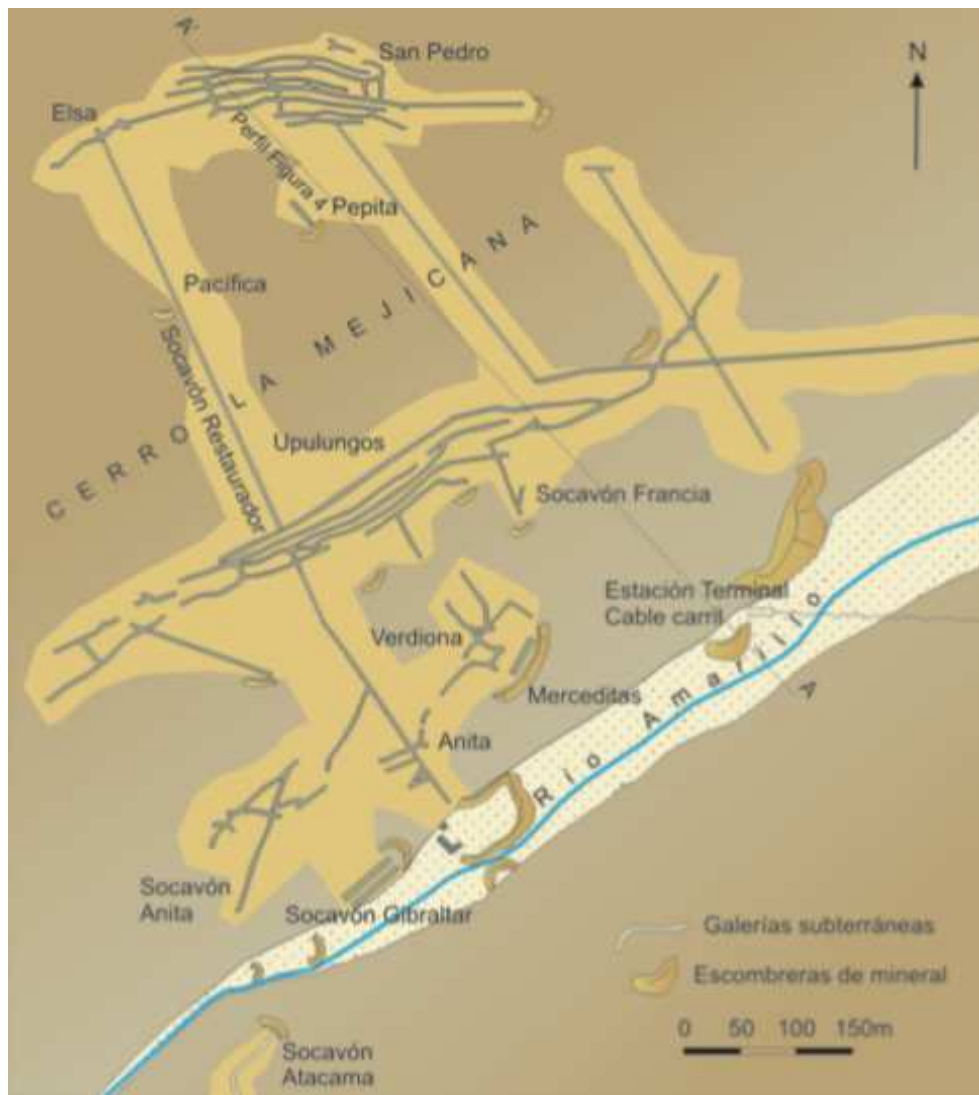
Fig. 44 : Schéma en vue aérienne des galeries de mine du complexe de La Mejicana. Il faut garder à l'esprit la variation de niveaux entre chaque galerie représentée, modifiant les distances relatives.
