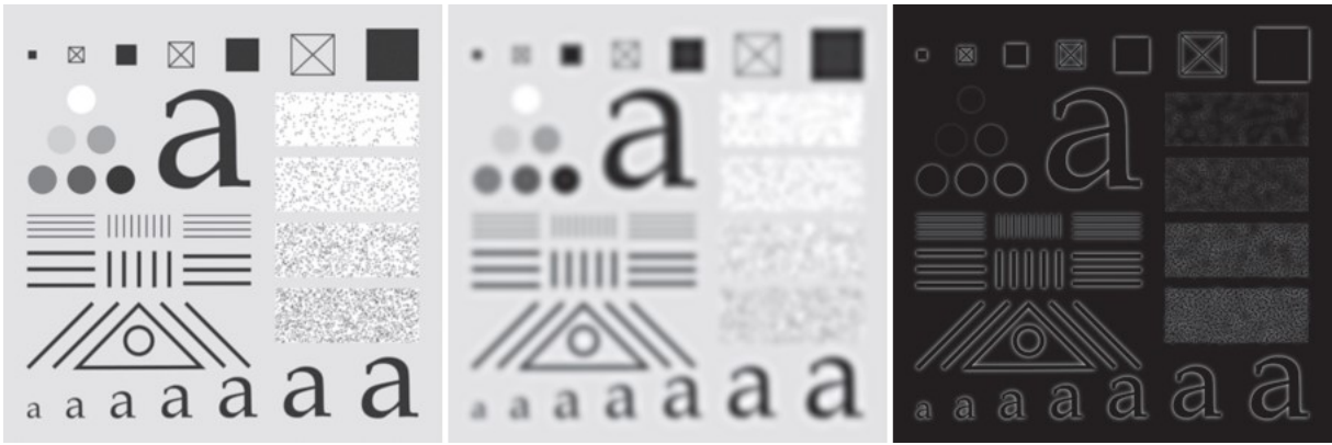
Figura 43 – Operazione di filtraggio nel dominio della frequenza. A sinistra l'immagine di partenza; al centro l'immagine filtrata con un filtro GLP con D_0 = 60 ; a destra l'immagine filtrata con un filtro GHP con D_0 = 60 . 112
