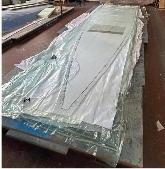
Figura 5.15: Coperta all'interno del sacco a vuoto aspirato per mezzo della pompa.
