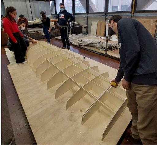
Figura 5.1: Struttura interna del master in seguito l'assemblaggio delle seste e paramezzale.
