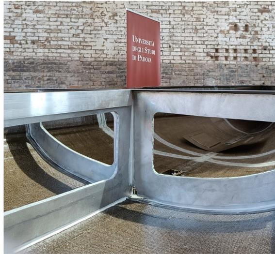
Figura 5.14: Immagine delle strutture interne fissate allo scafo.
