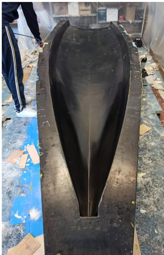
Figura 5.7: Lo Stampo ottenuto al termine della seconda fase del ciclo produttivo.
