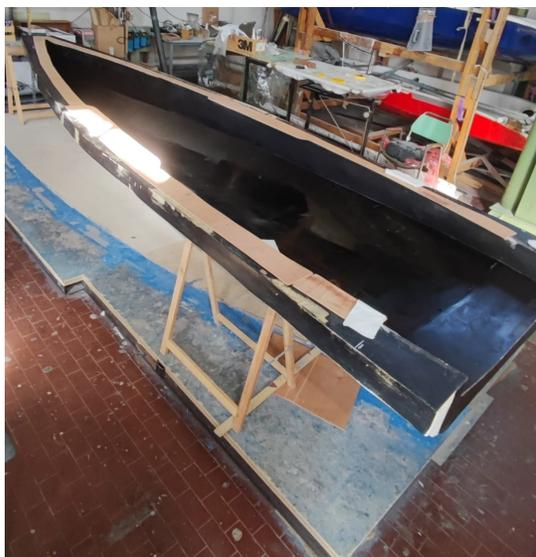
Figura 5.8: Applicazione delle flange ai bordi dello stampo.
