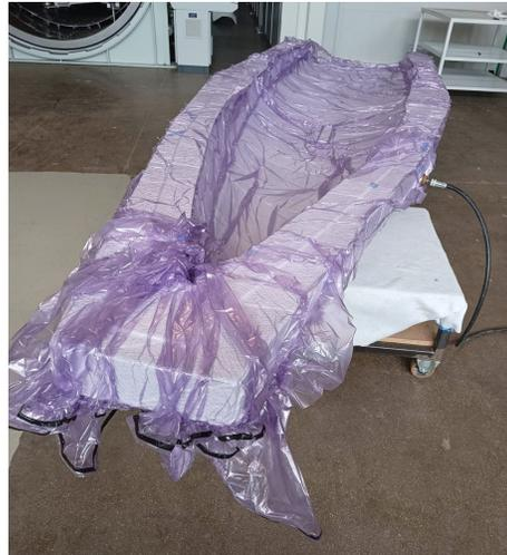
Figura 5.11: Scafo sottovuoto pronto per il processo di reticolazione finale in autoclave.
