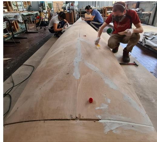
Figura 5.2: Operazione di stuccatura della superficie esterna del master chiusa dai pannelli flessibili.
