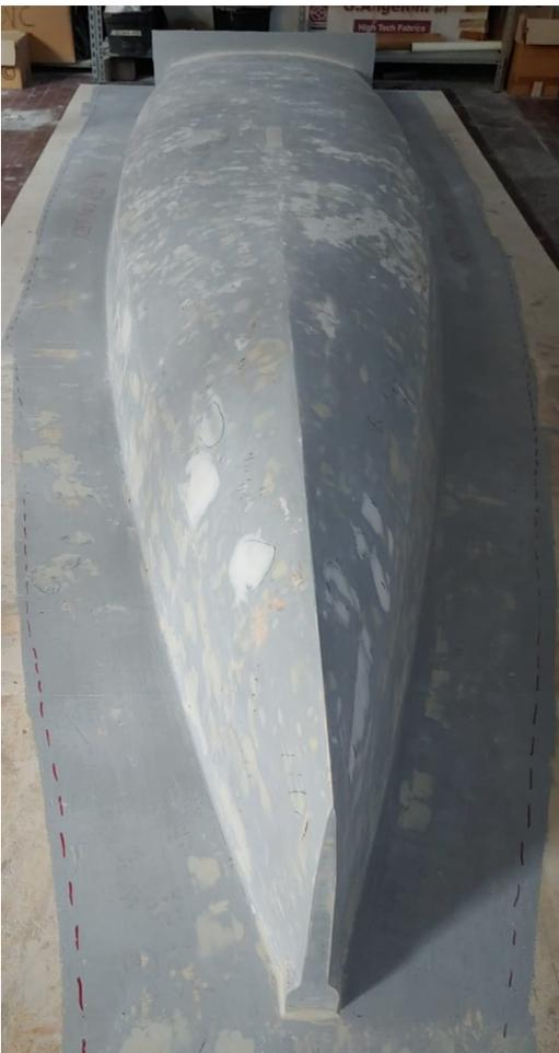
Figura 5.3: Risultato ottenuto al termine del processo di carteggiatura.
