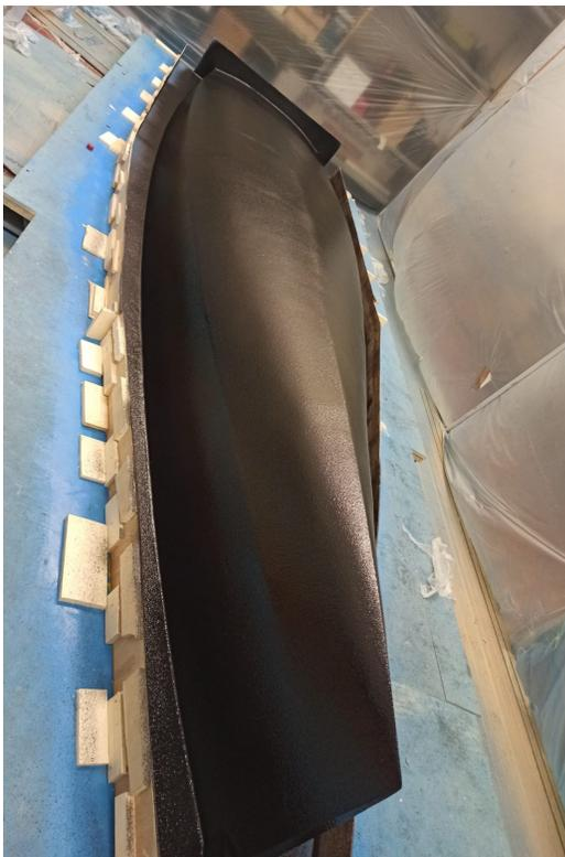
Figura 5.5: Applicazione dello strato di gelcoat sullo stampo.
