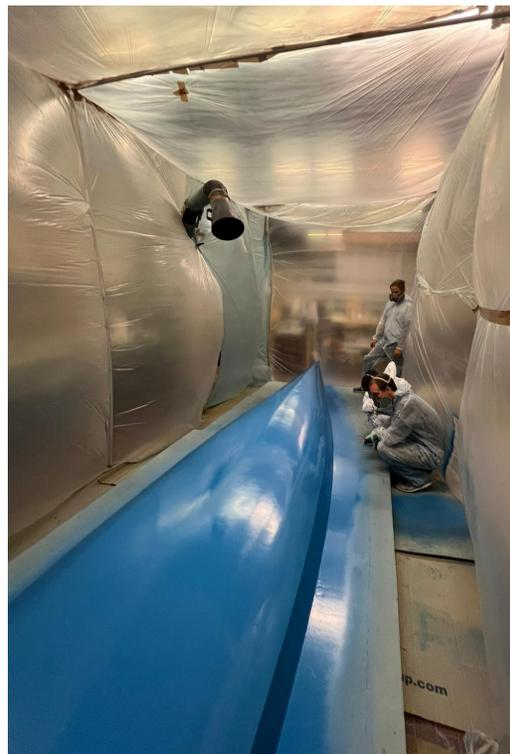
Figura 5.4: Master lucidato all'interno della camera d'aspirazione.
