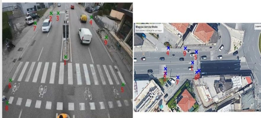
*Figura 14. Individuazione dei punti omografici grazie l'interfaccia di tracking.*
