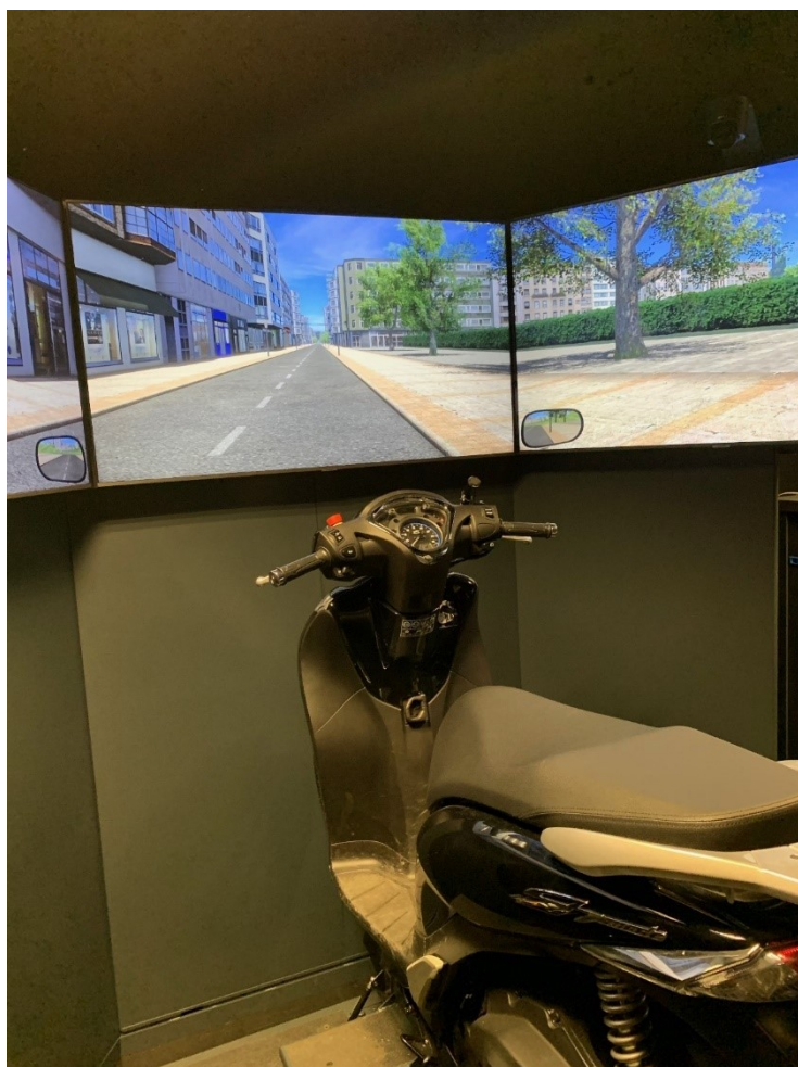
Figura 2. Il simulatore di motociclo Lander. Foto d'archivio.
