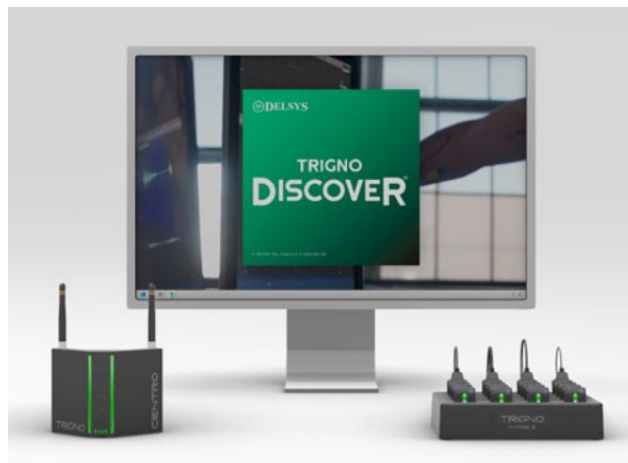
Figura 6: immagine del sistema Trigno. Da sinistra a destra: base ricevente, software di acquisizione e postazione di ricarica con i sensori
