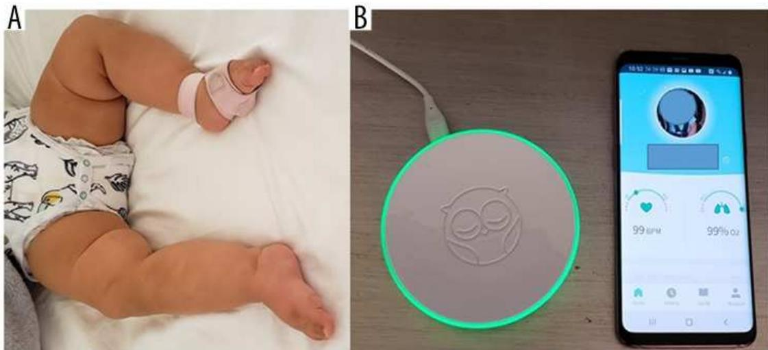
Figura 8. La calza Owlet indossata sul piede sinistro del neonato (A). È collegata alla stazione base tramite tecnologia Bluetooth (B). Le informazioni vengono inviate allo smartphone con un'applicazione in tempo reale tramite la stazione base (B).
