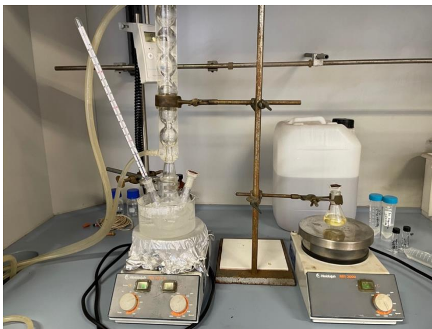
Figura 4.5.2: Setup sperimentale per la sintesi delle Ag NPs. A destra è presente la reazione per la formazione dei seeds , mentre a sinistra era già stata preparata la vetreria necessaria al successivo accrescimento. Tramite questa procedura è stato possibile elidere i tempi tra i due step sintetici, dovendo solamente prelevare 10 ml a dx per poi inserirli a sx.
