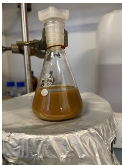
Figura 4.6.1: Reazione per la formazione dell'ossopolimero che successivamente procederà alla formazione della shell.
