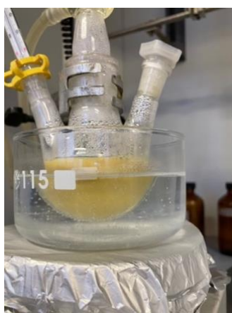
Figura 4.5.3: Ambiente di reazione dopo l'aggiunta dei seeds (a). Ambiente di reazione dopo l'aggiunta di acido ascorbico (b). Aspetto della sospensione al termine della reazione (c)
