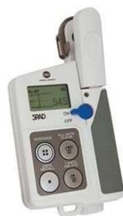
Figura 18 Sensore ottico SPAD 502 Plus.
