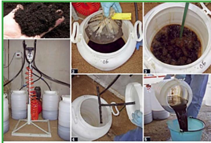
Figura 8 Processo di estrazione del compost tea: 1) impianto di estrazione simultanea con quattro fermentatori; 2) sacca di tessuto non-tessuto contenente compost; 3) fasi di aerazione; 4) apertura dl fermentatore a processo concluso; 5) recupero del CT (Crea e Mipaaf, Produzione aziendale e impiego di tè di compost per la biostimolazione e la difesa in orticoltura).
