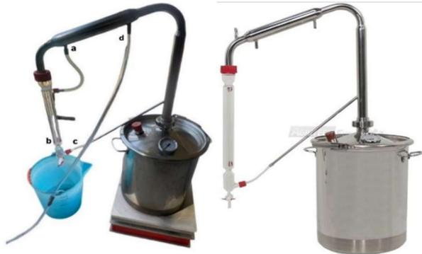
Figura 23 A sx) Estrattore utilizzato per la prova, con tubazioni con le seguenti finalità: a) flusso del vapore dalla camera all'ampolla b) deflusso dell'acqua in eccesso c) ritorno del vapore al recipiente in acciaio d) ingresso di acqua fredda per raffreddare la camera e innescare la formazione di vapore. A dx) Estrattore professionale per oli essenziali, in corrente di vapore.
