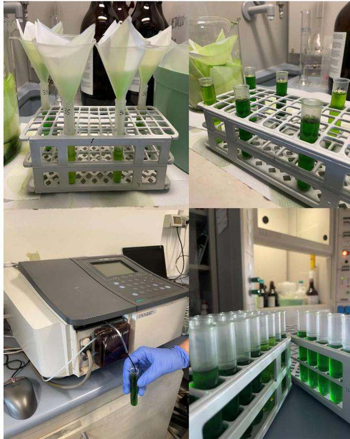
Figura 24 Determinazione dei pigmenti fotosintetici in laboratorio tramite analisi con spettrofotometro modello Shimadzu 1800 UV Vis.
