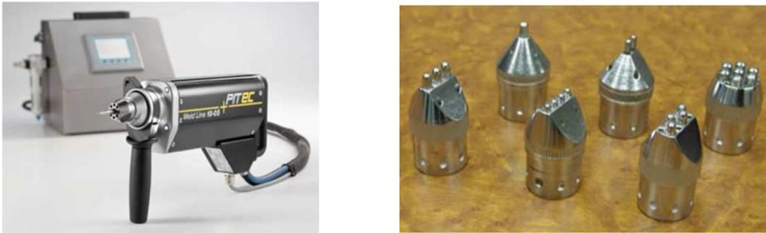
Figura 3.2: A sinistra si può vedere un dispositivo usato per l'applicazione del trattamento HFMI, a destra delle testine che presentano un vario numero di indentatori [1]
