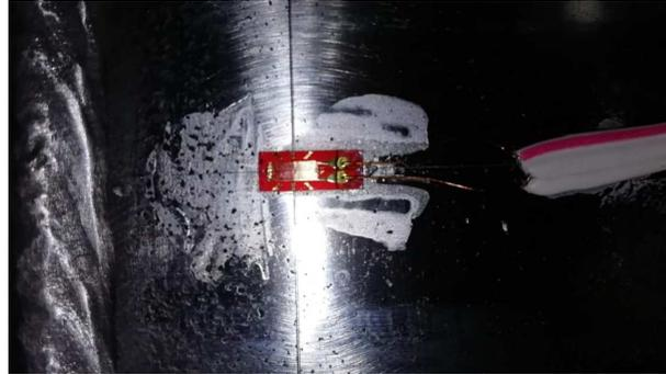
Figura 4.33: Risultato del corretto posizionamento di un estensimetro, si può vedere la griglia di riferimento dell'estensimetro perfettamente allineata con quella di riferimento
