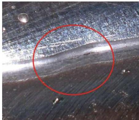
Figura 3.6: Possibile difetto nel trattamento [1]
