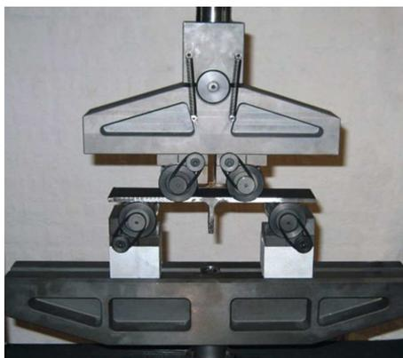
Figura 5.50: Fotografia del giunto trasversale a singolo irrigidimento M.M. Pedersen et al. (2009),[39], posizionato nella macchina di prova.
