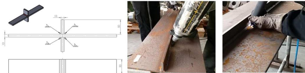
Figura 5.35: Disegno tecnico e fotografie del giunto trasversale a doppio irrigidimento J. Schubnell et al. (2023) [32]
