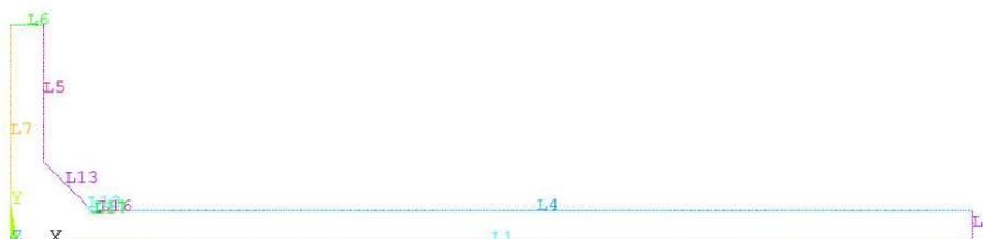
Figura 5.83: Geometria giunto trasversale a doppio irrigimento V. Knysh et al. (2021).
