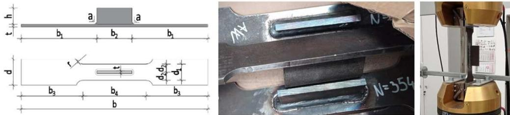
Figura 5.108: Disegno tecnico e fotografie del giunto Longitudinale a singolo irrigidimento B. Fustar et al. (2024)
