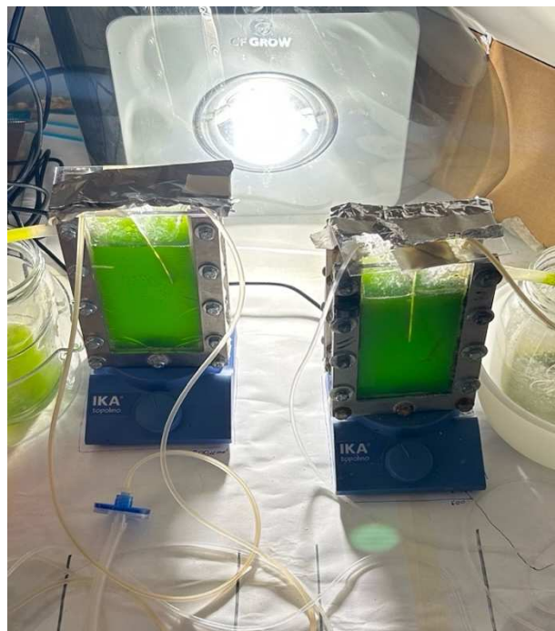
Figura 2.2: Setup sperimentale in incubatore dei Flat-panel PBRs operanti in continuo in modalità chemostat.
