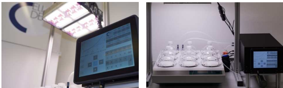
Figura 2.6: Sistema di illuminazione LED e GCU per il controllo dei parametri (a sx); GCU e piattaforma di coltivazione del sistema Cell-DeG (a dx)[95].
