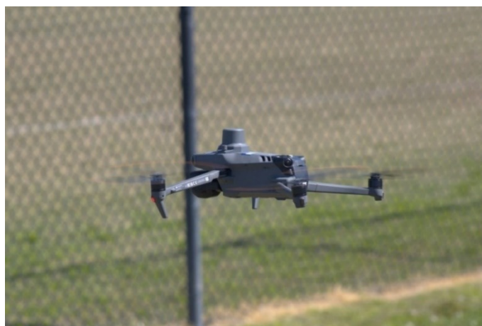
Fig.3.4.1: foto del drone DJI MAVIC 3 ENTERPRISE.
