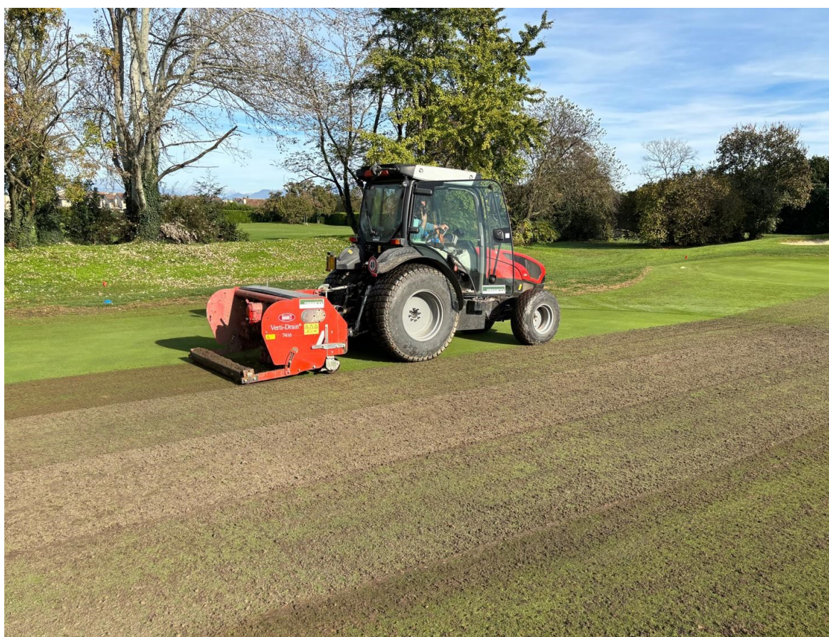
Figura 33: attività di carotatura svolta dalla ditta esterna, a terra si possono osservare i piccoli cilindri, o carotine, di terreno estratti dall'operazione
