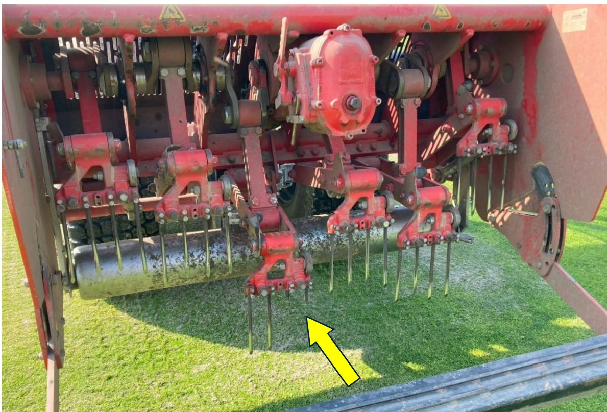
Figura 32: la freccia gialla indica i due chiodi rotti, si può inoltre notare il generale stato di usura dei chiodi e la struttura di questa particolare macchina
