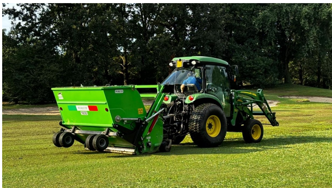
Figura 36: trattore John Deere 4720 e trinciaerba Peruzzo Panther multifit 1800 mentre esegue il verticutting sul fairway della buca 2 del Golf Club Ca' Amata
