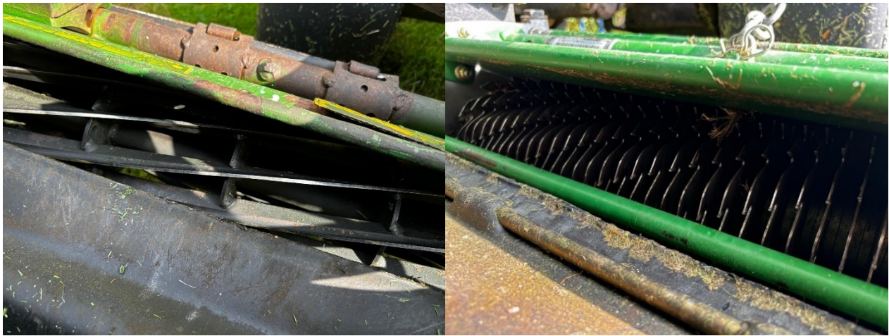
Figura 26: a sinistra gruppo di taglio con cilindro dotato di lame elicoidali mentre a destra cilindro composto dai dischi per l'esecuzione del verticutting
