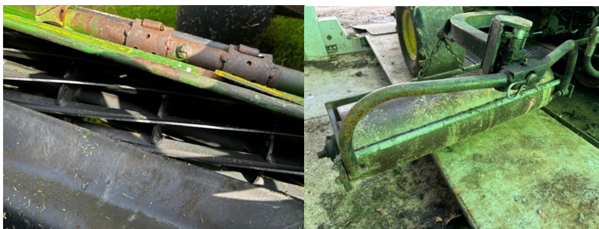
Figura 30: a sinistra gruppo di taglio con lame elicoidali mentre a destra rulli di ferro per eseguire la rullatura
