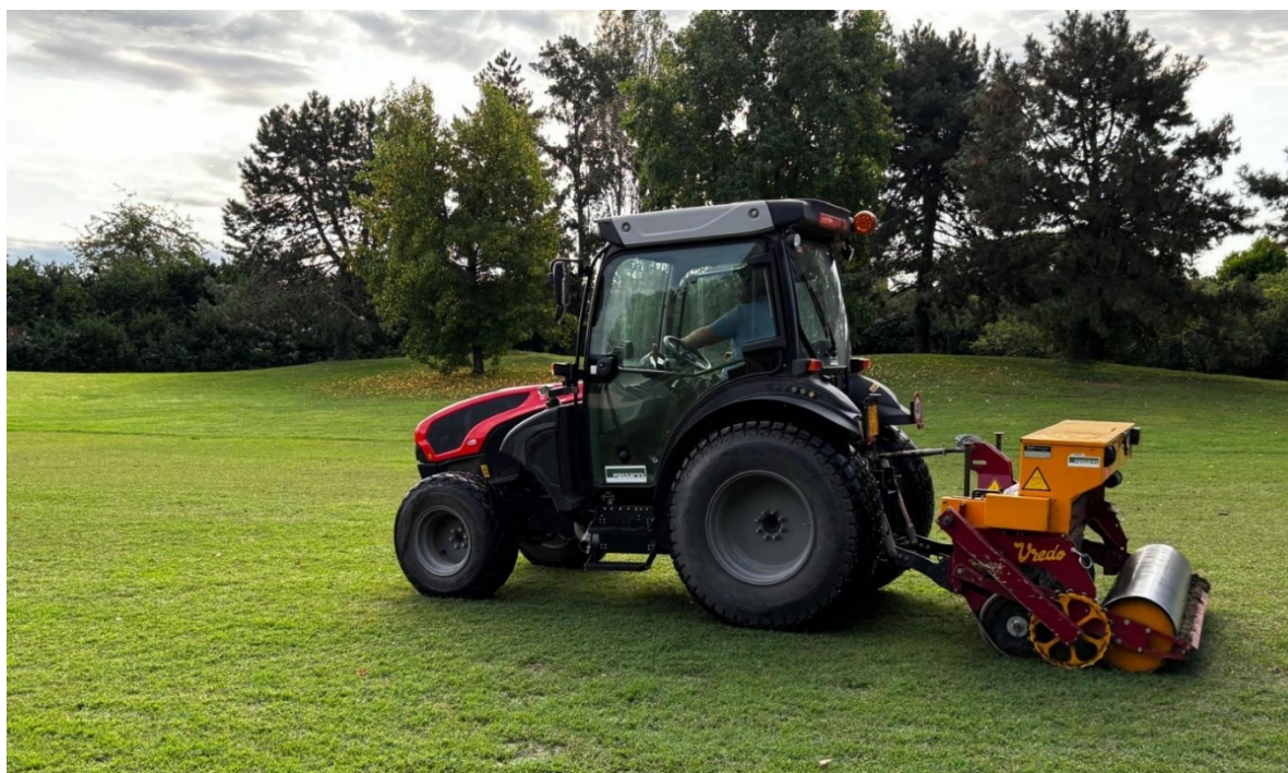
Figura 38: esecuzione della trasemina sul fairway della buca 1 al Golf Club Ca' Amata con un tappeto erboso in condizioni discrete
