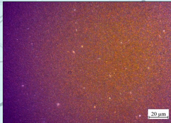
TiO 2 2 mm 1h sinterizzazione a 600 °C
