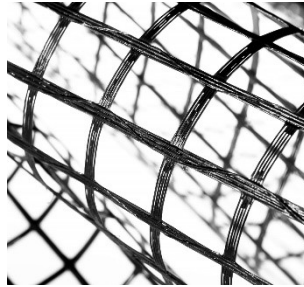
Figura 6 – esempio di geogriglia tessuta a struttura piana e forma reticolare, realizzata con filamenti di poliestere ricoperti da strato protettivo in resina di PVC (catalogo Geosintex)
