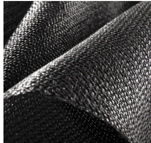
Figura 4 – esempio di geotessile tessuto in fibre di polipropilene (catalogo Geosintex)
